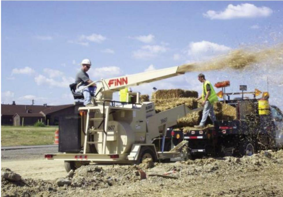
Figure 4 : Exemple de paillage d'un sol nu par projection (Source : ONEMA, 2016<sup>3</sup>)
