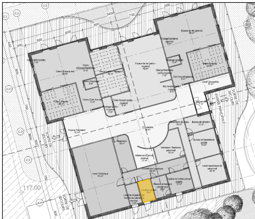
Figure 391 : Local poubelles de la crèche (source : assar architects)
