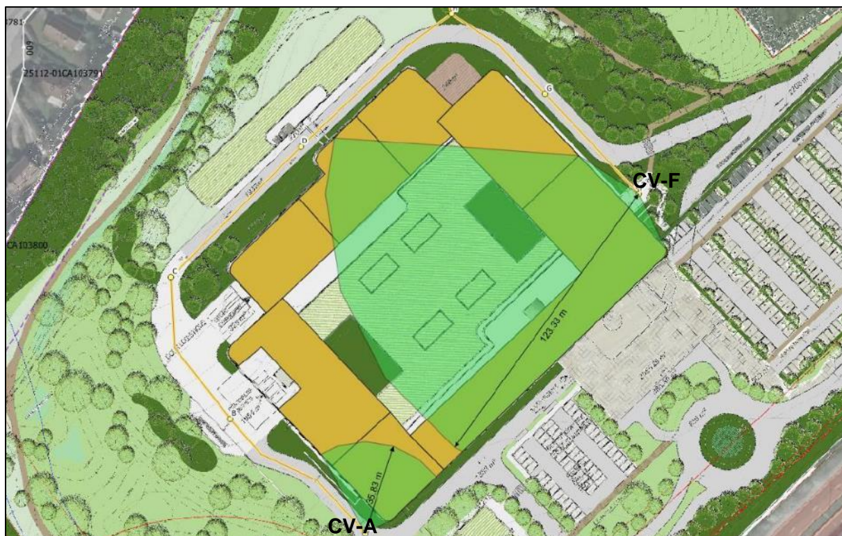
Figure 318 : Rayons de captage des usées du -2, depuis CV-A et CV-F
