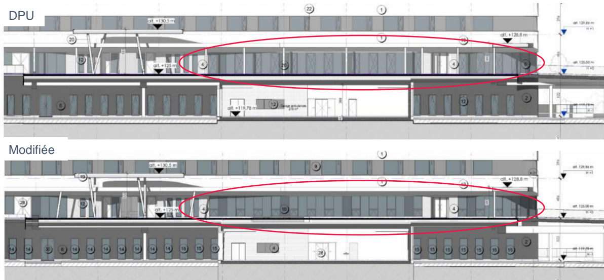
Figure 34 : Réduction de la hauteur des ouvrants, ici du RDC (source : ASSAR)
