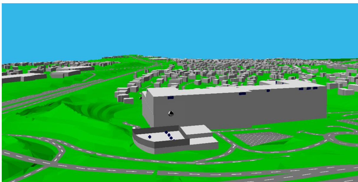
Figure 39 : vue 3D du nouveau merlon et de la modification du bâtiment « power house/radiothérapie) intégré dans le modèle CadnaA (source : ASM Acoustics)
