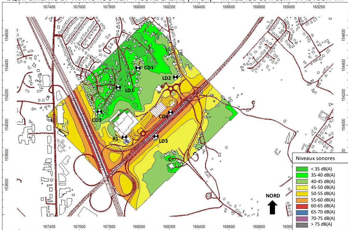
Figure 44 : Comparaison des cartes de bruit en situation projetée sans merlon (figure du haut) / avec merlon (figure du bas) - Equipements et trafic routier – Heure calme (4h-5h)
