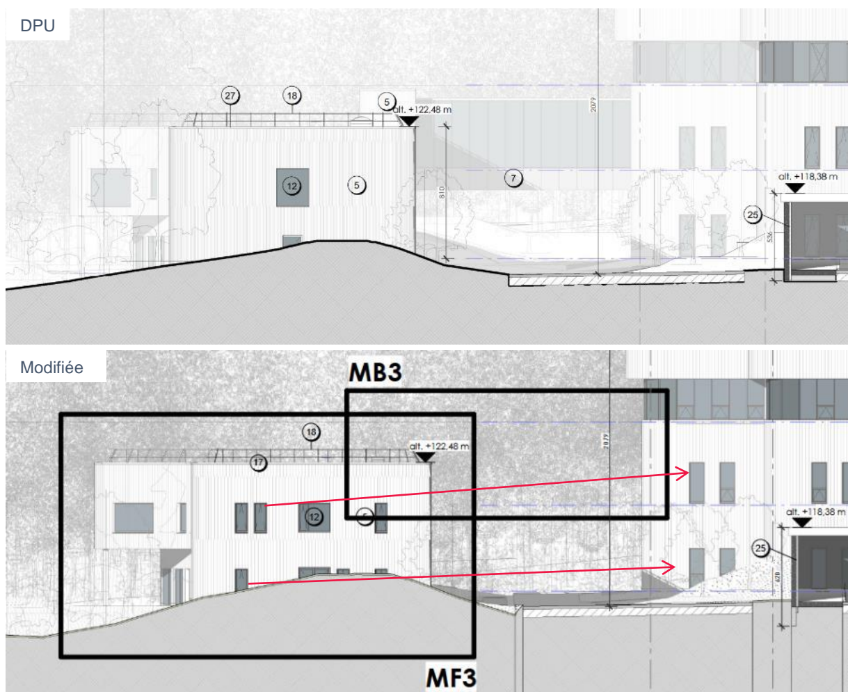
Figure 32 : Modifications de la façade du pavillon de psychiatrie (source : ASSAR)
