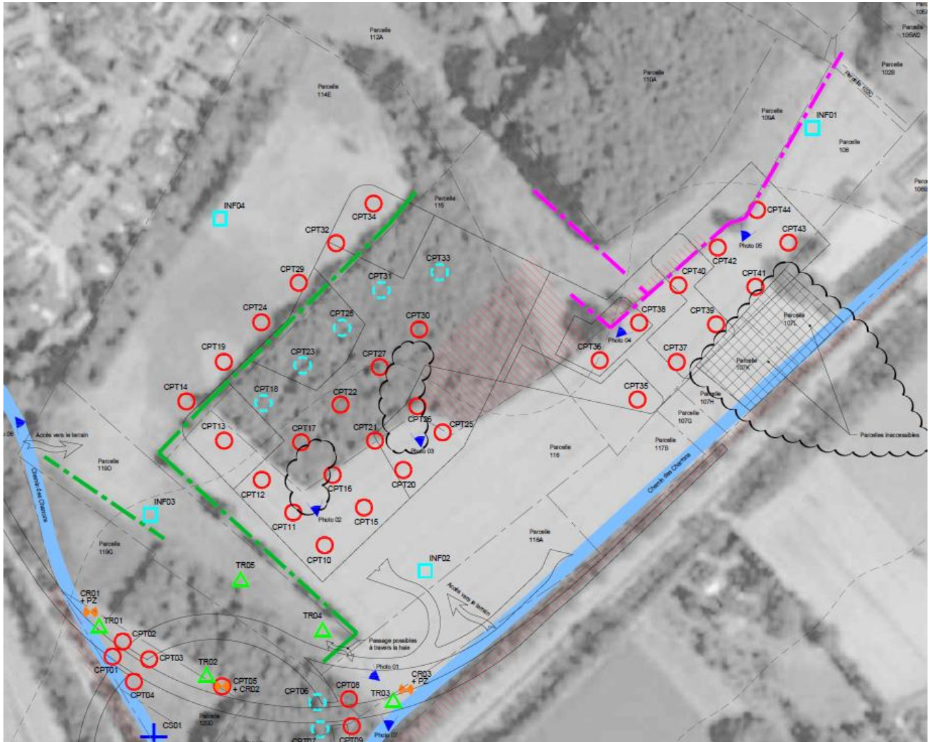
Figure 5 : Implantation des essais d'infiltration (carrés bleus)
