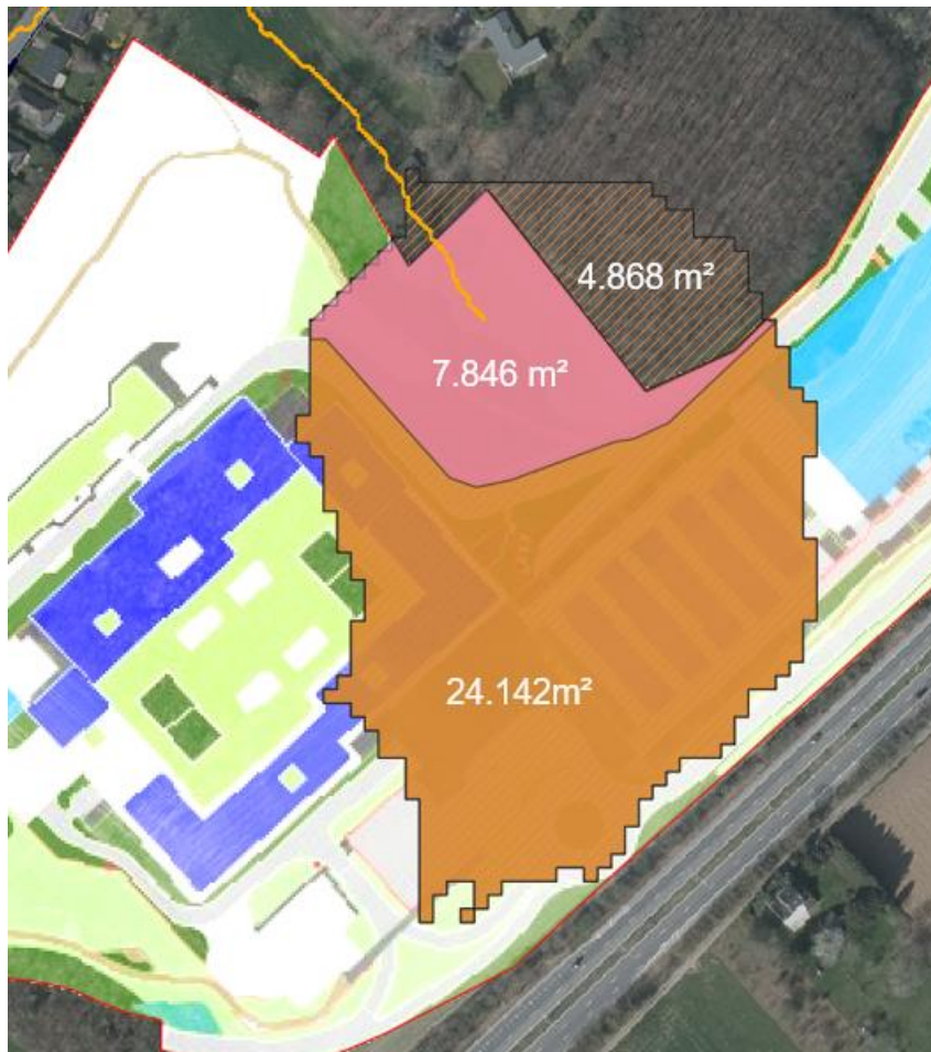
Figure 25 : Surface contributive gérée par des ouvrages de rétention et d'infiltration (orange), surface contributive restante au sein du site (rose) et surface contributive hors du site (hachurée)
